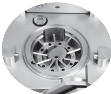
Rotor 10 palettes. Moteur rotor piloté par servo moteur.
